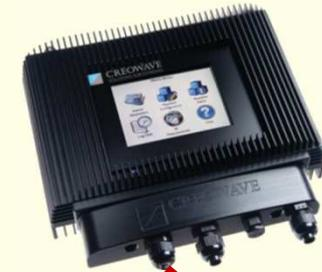
Alle Komponenten eines Systems können von einer Zentrale fernkonfiguriert und überwacht werden. Hierzu werden die LWL-Übertragung oder GSM-Modems verwendet
